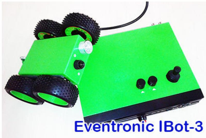
La consola de mando permite controlar los movimientos del robot, velocidad de los motores e intensidad de la luz.
