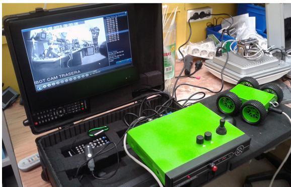
Con los 25 metros de cable tendrá cubiertas todas las necesidades de videoinspección en las condiciones más difíciles. El cuerpo del robot va protegido con pintura de poliuretano para soportar condiciones adversas de suciedad y contaminantes químicos.
